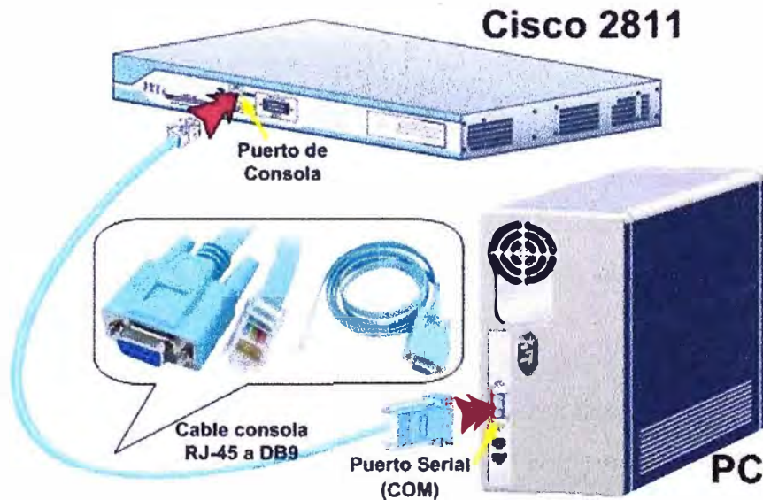
Figura 3.40 Interconexión del router y la PC
