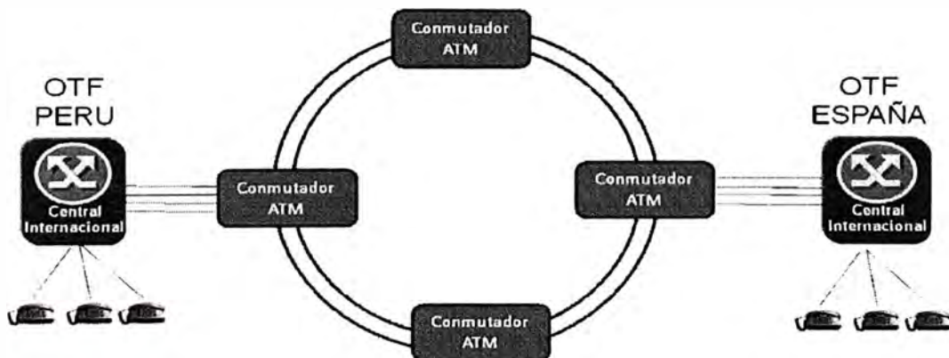
Fig. 1.2. Esquema de Interconexión empleando redes ATM
