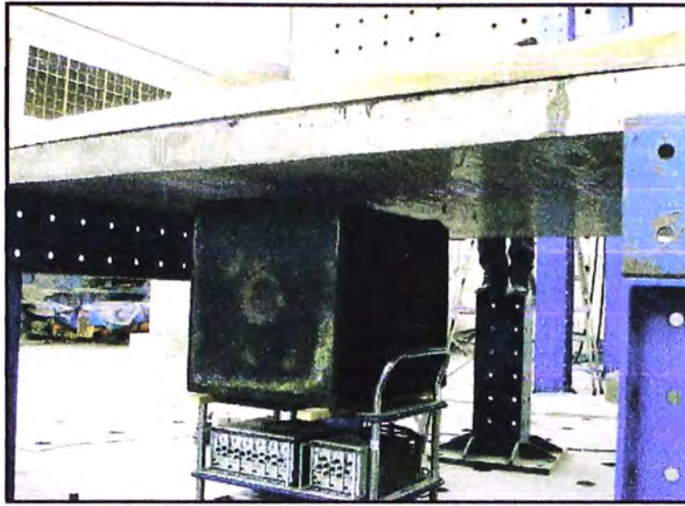
Figura 4.14: a) Diagrama experimental propuesto para la generación y análisis óptico de vibraciones, b) Vista real del arreglo experimental
