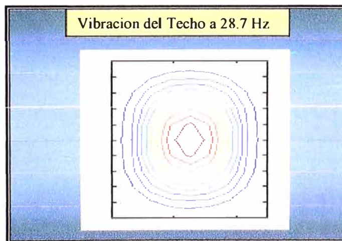
Figura 4.26: Patrón de vibración mas probable, que se establece en el techo, al ser excitada a la frecuencia de 28,7 Hz.
