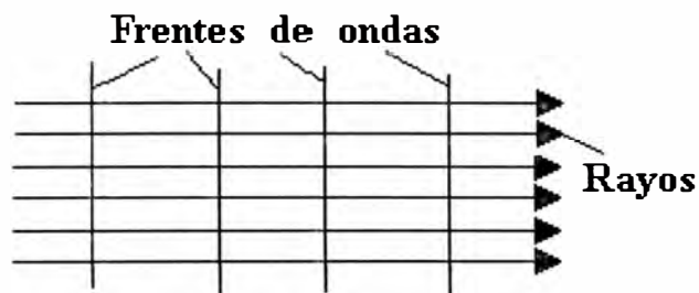
Figura 2.7 Frente de onda plana
