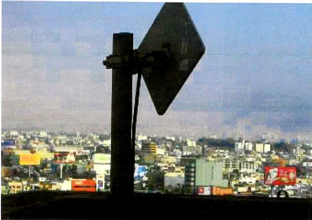
Figura B.5 Antena 5.8GHz integrada de 22dBi
