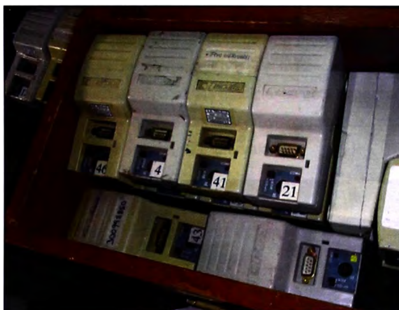
Figura 2.7 Se muestra en la parte superior las fotos de un Registrador de Tensión marca Circuito, modelos CAVA 251 y en la parte inferior a un conjunto de Registradores de Tensión en su caja de almacenamiento
