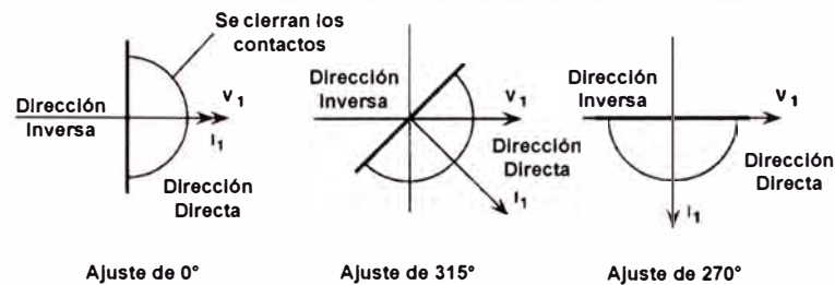
Figura 1-2. Ejemplos de Ajustes - Angulos de Par Máximos del Elemento 67P
