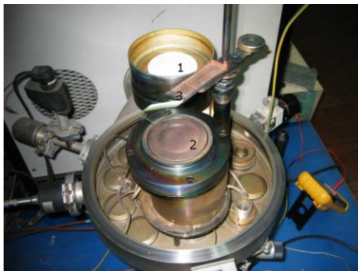
Figura 3.2: Interior de la cámara de vacío del sistema UNIVEX 300 mostrando el segundo cátodo adaptado: (1) y (2) son los cátodos y (3) el portamuestras.
