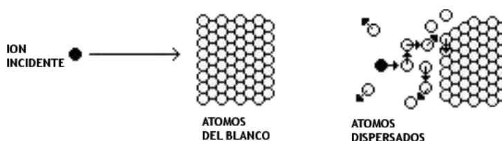
Figura 2.1: Esquema del modelo del juego de billar para explicar el fenómeno de sputtering. Los átomos salen de la superficie por intercambio de momentum.
