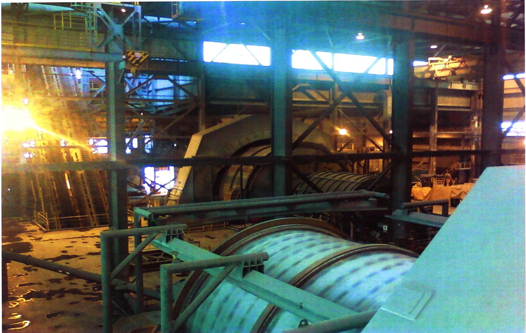
Figura 1.3 En la figura se muestra al molino de bolas v al molino SAG (fuente: minera Antamina)
