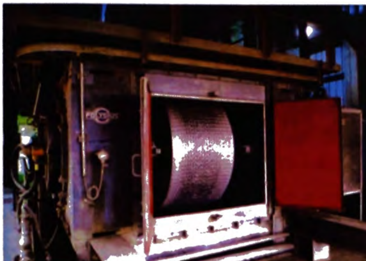
Fig 2.4 Prensa de Rodillos Krupp Polysius, vista del rodillo móvil.
