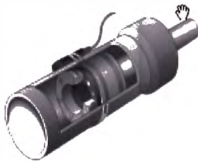
Fig. 4.27 Sensor magnético instalado en el pistón.
