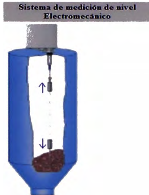
Fig. 4.13 Medición de nivel electromecánico
