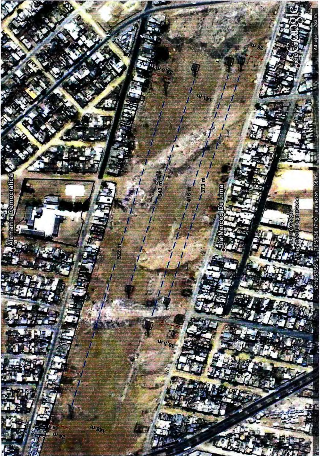
Líneas de transmisión de 220 kV, longitud de vanos y faja de servidumbre.
