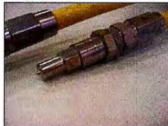
Fig. 2.28 Terminal de Línea (Fuente Minesite.com.au).
