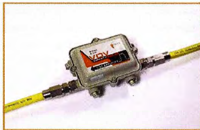
Fig. 2.25 Amplificador instalado (Fuente Minesite.com.au).
