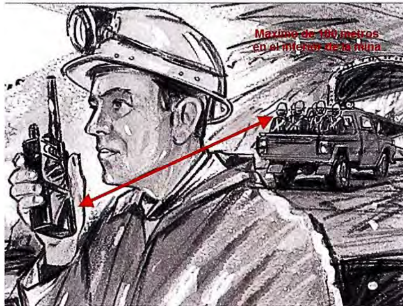
Fig. 2.4. Alcance de las radios portátiles en el interior de la mina (Fuente www.minecom.com )
