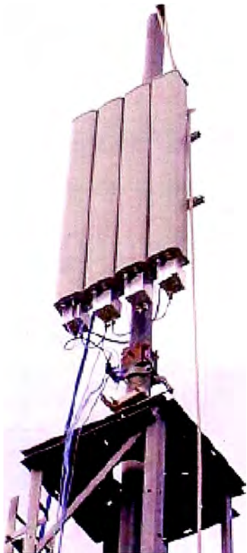
Fig.1.16 Antena Inteligente Arreglo lineal Fuente: Semi-Smart Antenna Technology Project
