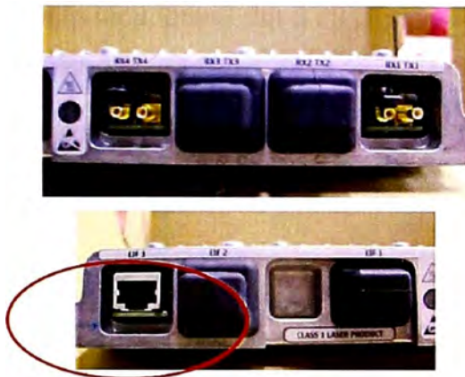
Fig. 3.25 Módulo con 4 puertos coaxiales, 2 puertos Ethernet y un puerto Gigabit ethernet Fuente: Elaboración Propia
