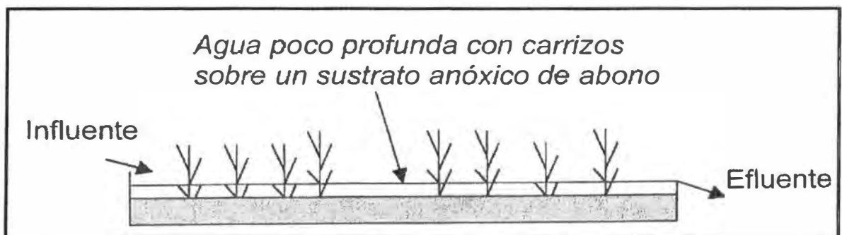
Fig. 12 Perfil Esquemático de un Humedal de Abono
