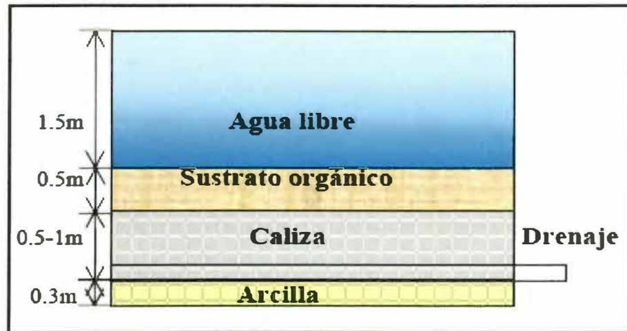
Fig. 11 Representación esquemática de un sistema SAPS (modificado de Younger, 1998)
