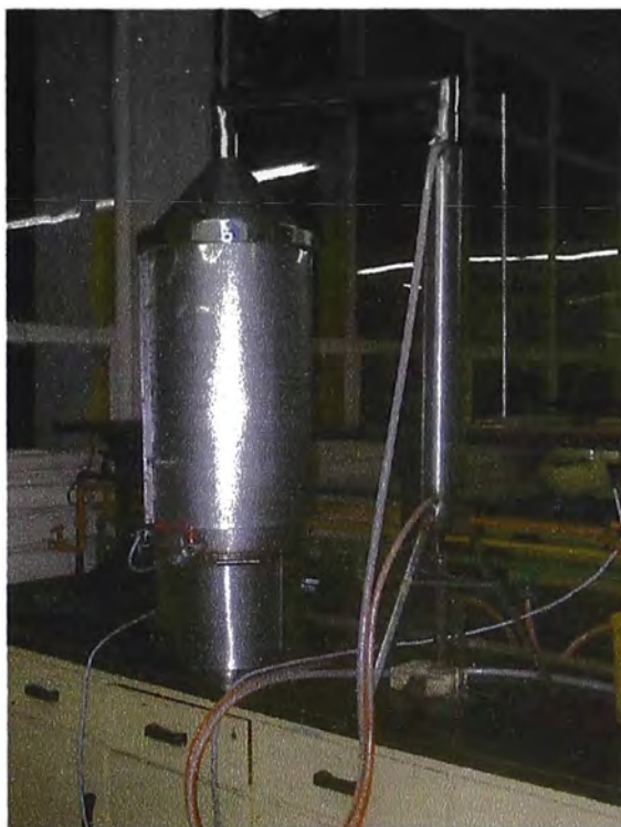
Figura 16. Equipo de Extracción de Aceites Esenciales (Romero P. y Breña J. 2010)
