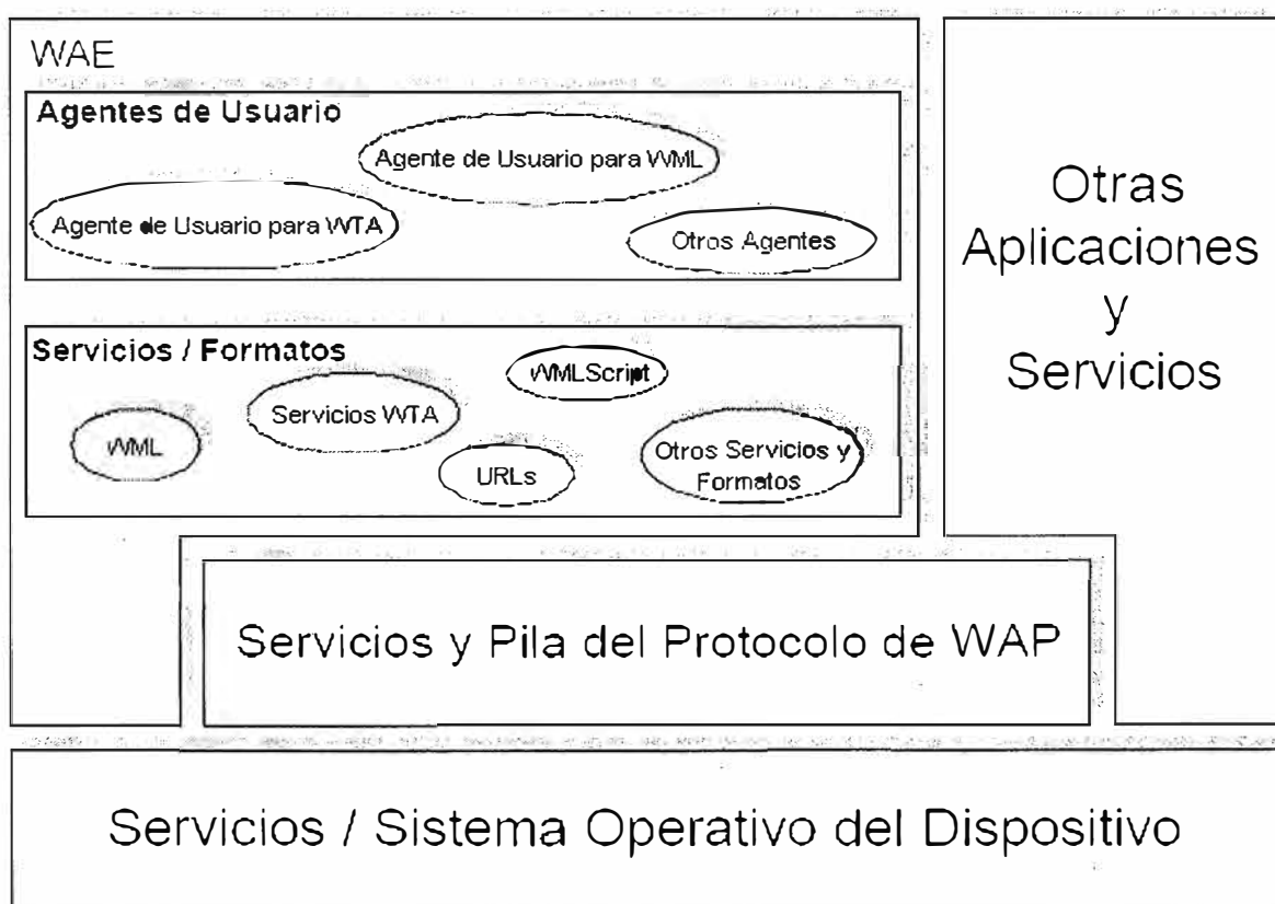
Fig. 3.5 Componentes del Cliente de WAE
