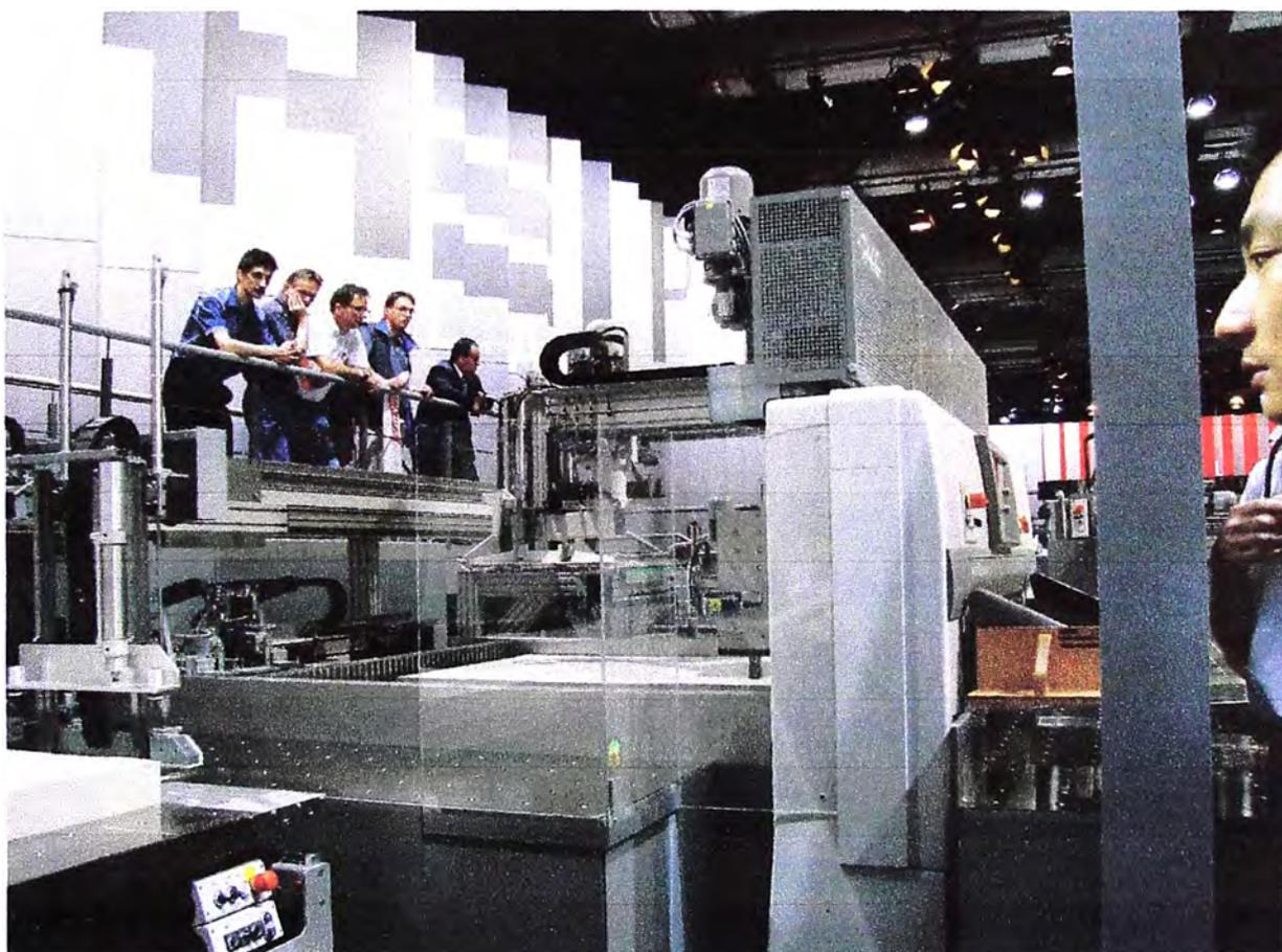
**Figura 4.2. Guillotina con brazos neumáticos para el ingreso y salida de papel**
