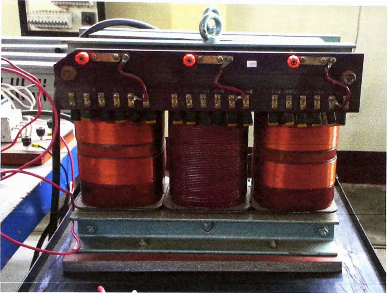
Fig. A1 Transformador de 6kVA usado en el ensayo
