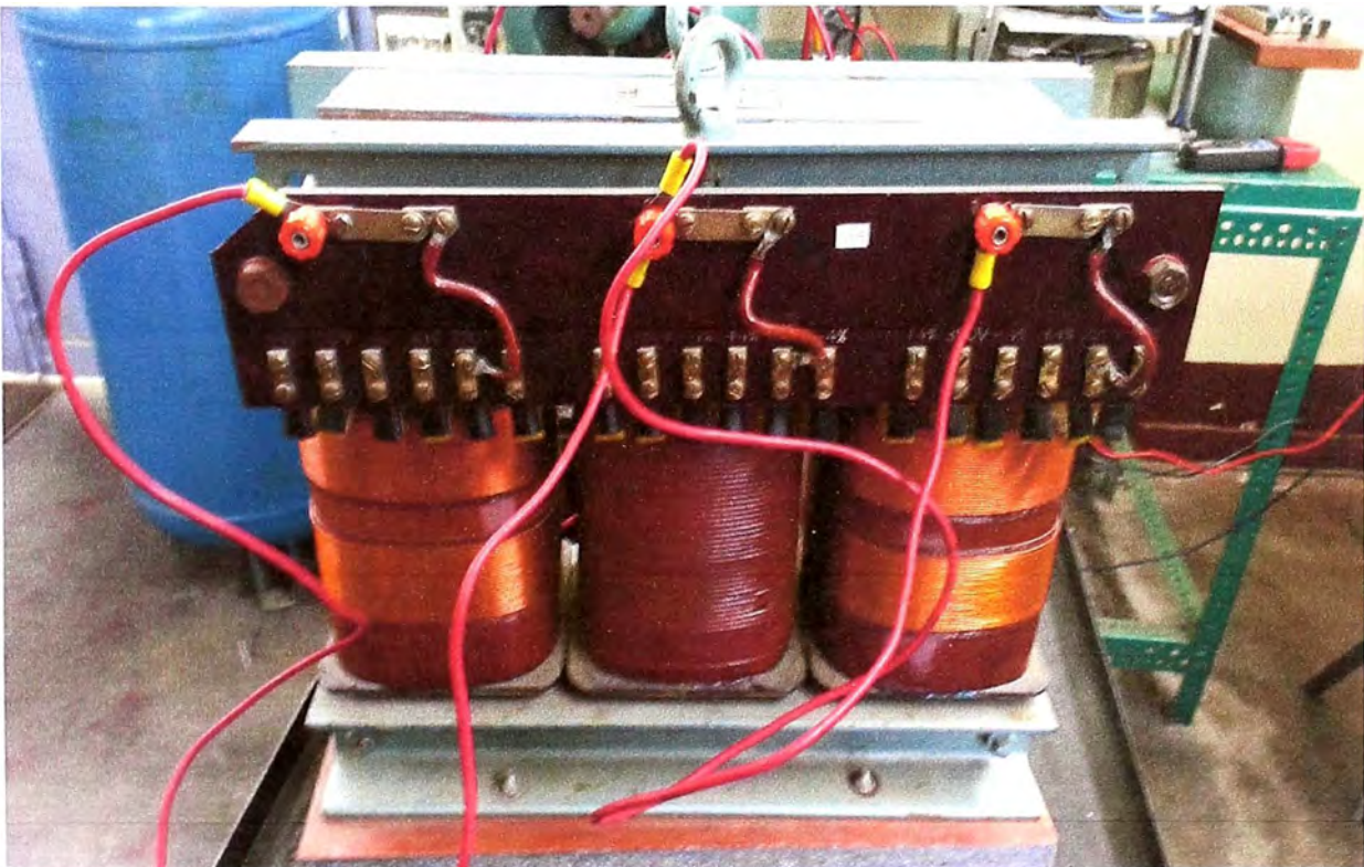
Fig. A4 Prueba de Cortocircuito
