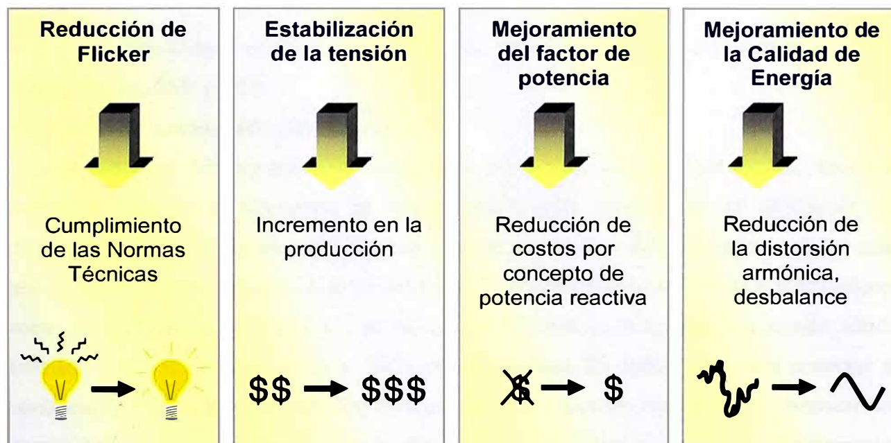
Fig. 2.10: Beneficios de utilizar un SVC en una planta de acería [6]
