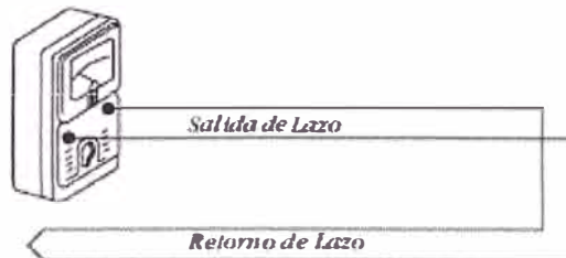
Fig. 3.9 Mediciones de la Resistencia de bucle de un lazo SLC de 4 hilos
