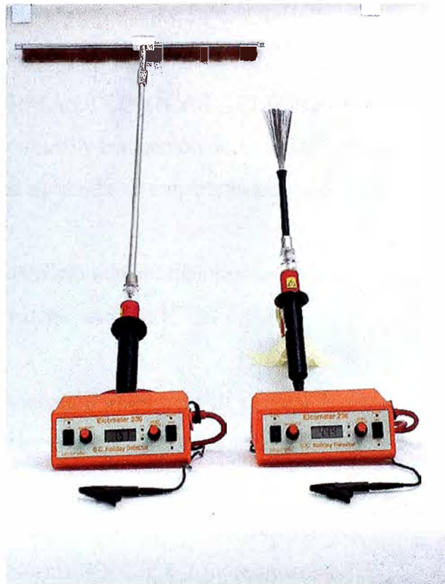
Figura 15 : Fotografía de un Holiday Detectors (detector de pin holes), equipos de alto voltaje para trabajos pesados de evaluación de la continuidad del sistema de pinturas tanto en áreas planas como estructuras, tuberías, vigas, perfiles, etc
