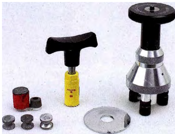
Figura 14 : Medidor de adherencia cuantitativa entre el sistema de pinturas y el sustrato en Kg/cm 2 ó psi. Norma ASTM 4541.
