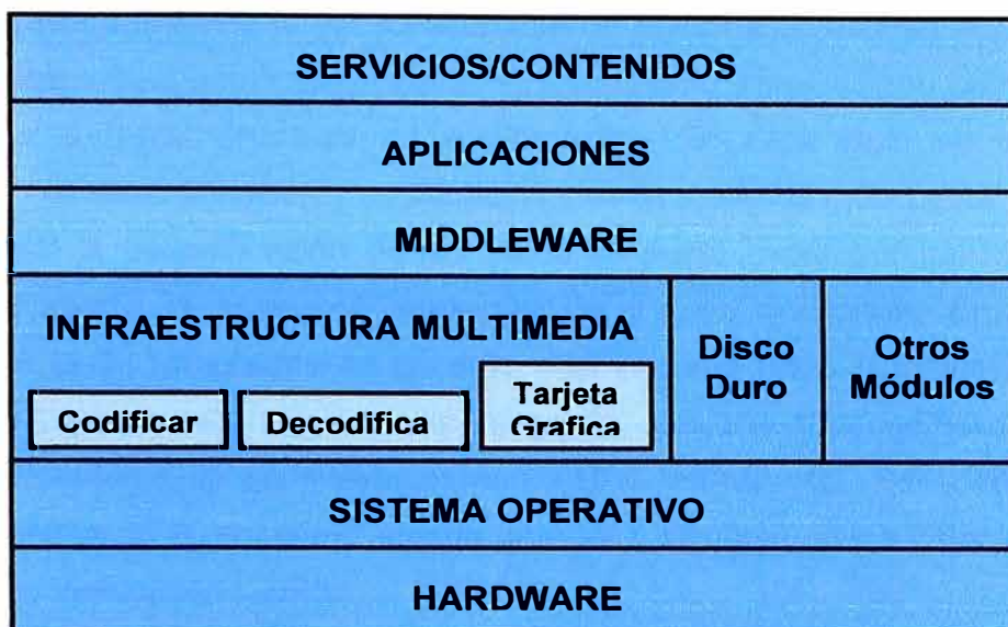
Figura 2.5 Arquitectura general de un Set Top Box
