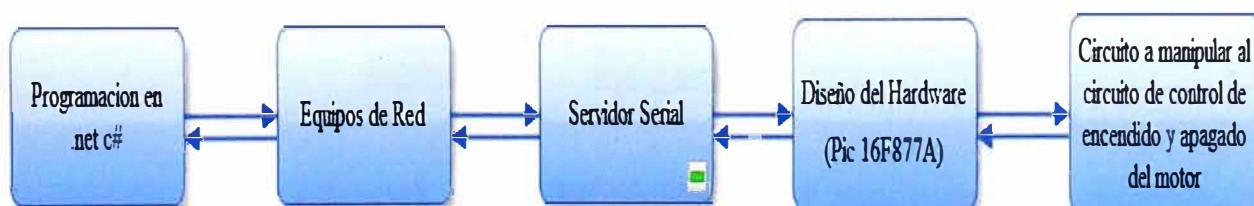
Figura 1.1 Diagrama de bloque en lazo directo para el control a distancia el arranque y apagado de un motor eléctrico
