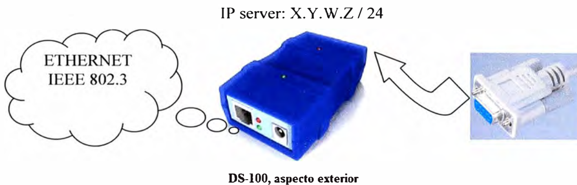
Figura 3.19 Conexión en la conversión de protocolos usando el servidor serial tibbo DS100
