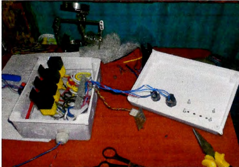
Figura 3.26 Ensamblado del circuito de control con relays
