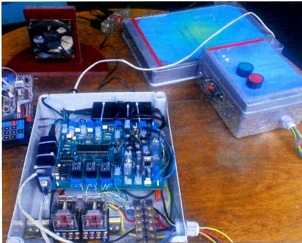
Figura 3.27 Pruebas en forma local el circuito de control PIC y el circuito de control del relevador para arrancar y apagar el ventilador dc
