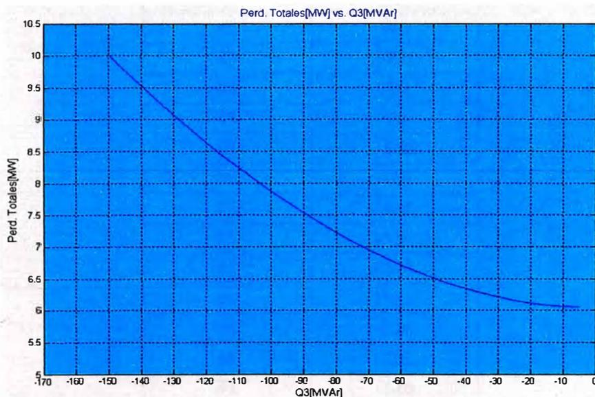
**Fig. 4.13** Pérdidas[MW] vs.  $Q_3$ [MVar] para el sistema eléctrico de 5 barras sin SVC
