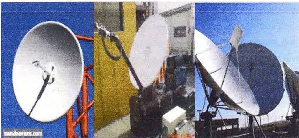
Fig. 3.5.3 Enlaces de microondas, fly-away, recepción satelital (Fuente: TV PERU)
