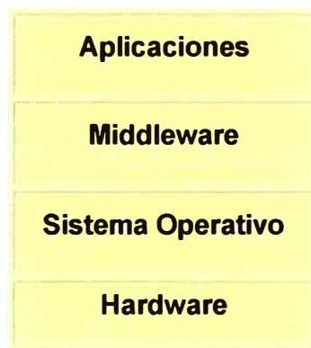
Figura 3.1 Arquitectura General de un Receptor one-seg
