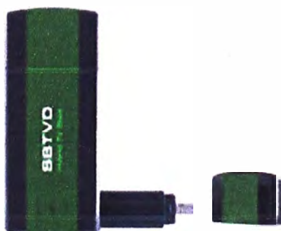
Figura 3.16. Sintonizador TV Digital y Analógica Mygica U6813
