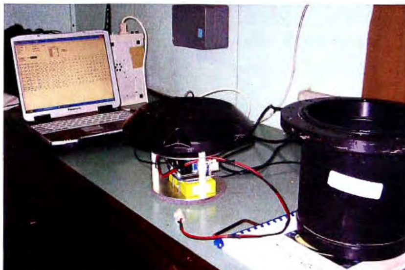
Fig. 5.4: Activación del tracker y verificación con el receptor portátil Argos
