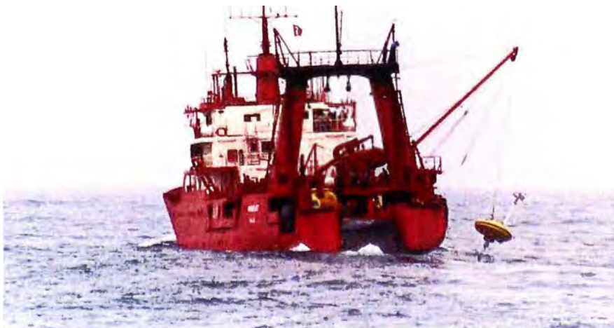
Fig. 5.6: Puesta de la boya en el mar por la banda de estribor
