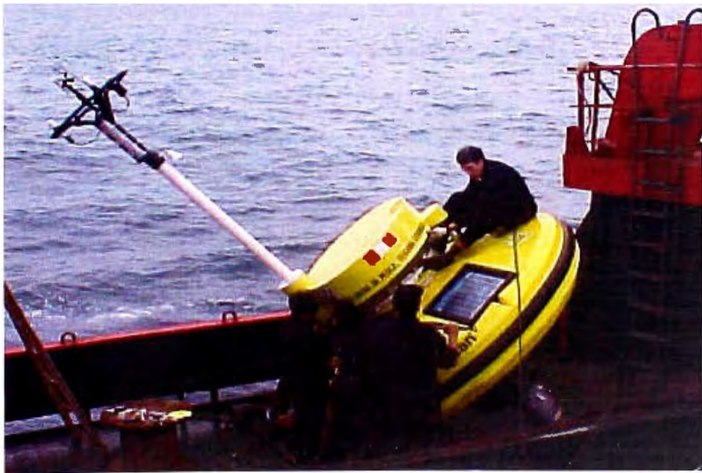
Fig. 6.5: Boya Virgen del Carmen instalada en agosto 2002 con sistema antivandalismo inicial: marcos y tapa de seguridad
