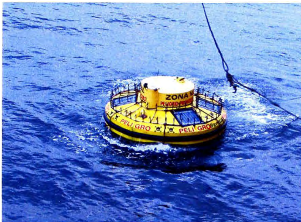
Fig. 5.7: Boya en el agua después de la activación el gancho liberador
