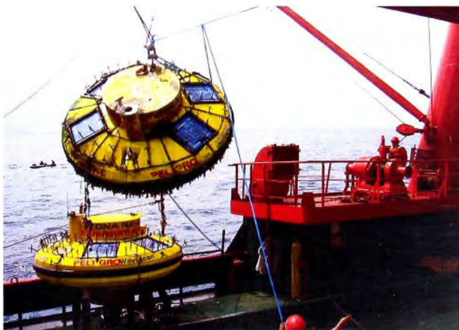
Fig. 5.16: Puesta de la boya izada en la cubierta del buque
