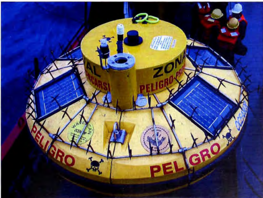
Fig. 6.9: Boya Virgen del Carmen con nuevo modelo de antena, preparada para el segundo recambio en junio del 2007
