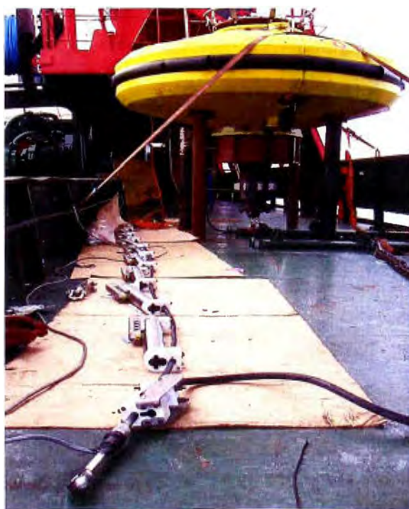
Fig. 5.3: Pruebas de comunicación de los sensores CT y CTD de la boya
