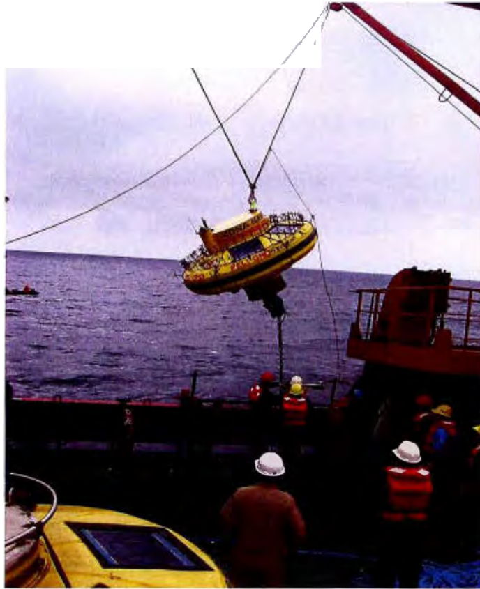
Fig. 5.19: Izamiento de la boya de recambio
