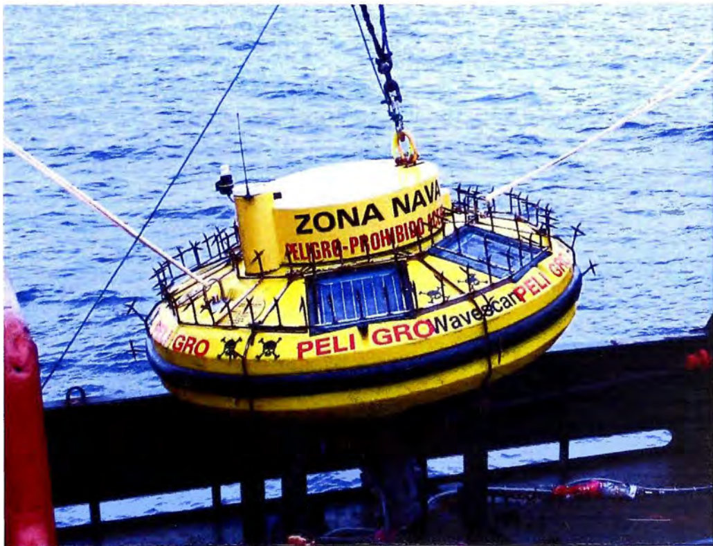
Fig. 6.7: Boya Virgen del Carmen instalada en octubre del 2005 con sistema antivandalismo final: tapa de seguridad, púas y reubicación de la antena por eliminación del mástil
