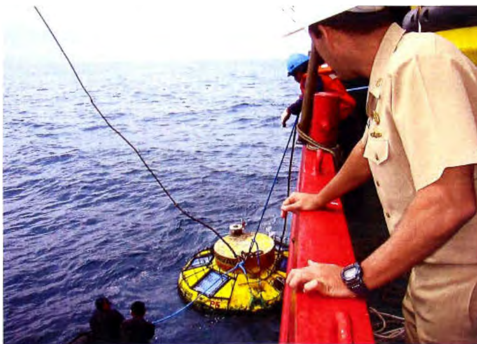
Fig. 5.14: Colocación del gancho de recuperación para izado de la boya
