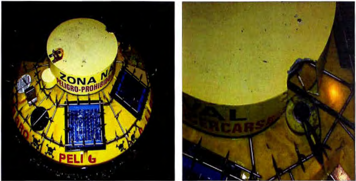
Fig. 6.6: Boya San Pablo II instalada en diciembre 2002 con estructura de púas adicional donde se aprecia que el mástil fue arrancado
