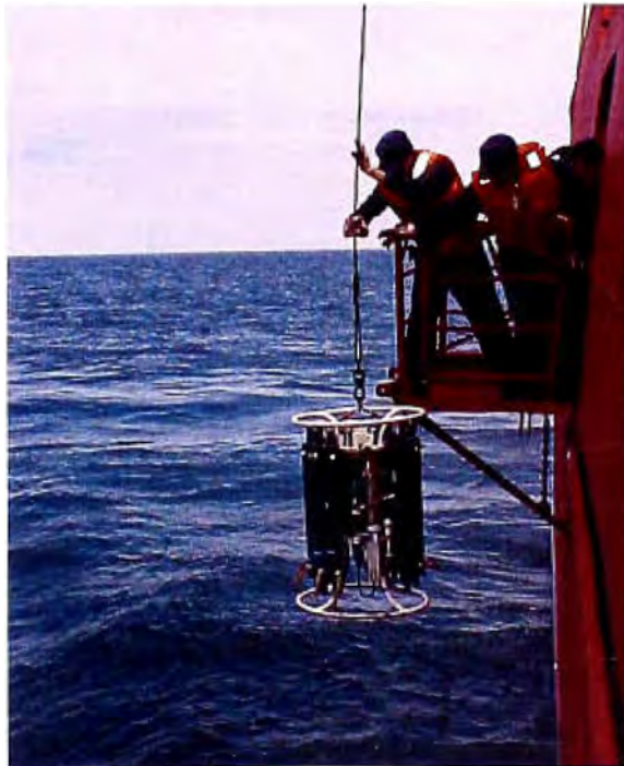
Fig. 5.11: Lanzamiento del CTD SBE19 para comparación de los datos transmitidos por la boya
