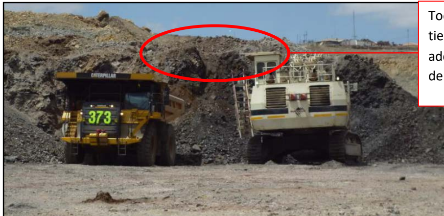
Figura 41. Frente con adecuada fragmentación.
