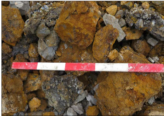
Figura 30. Fotografía disparo zona sur malla 5.7mx6.5m.
