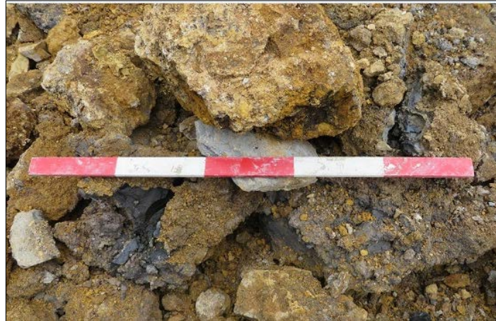
Figura 34. Fotografía disparo zona sur malla 6.1mx7.0m variando la carga explosiva.
