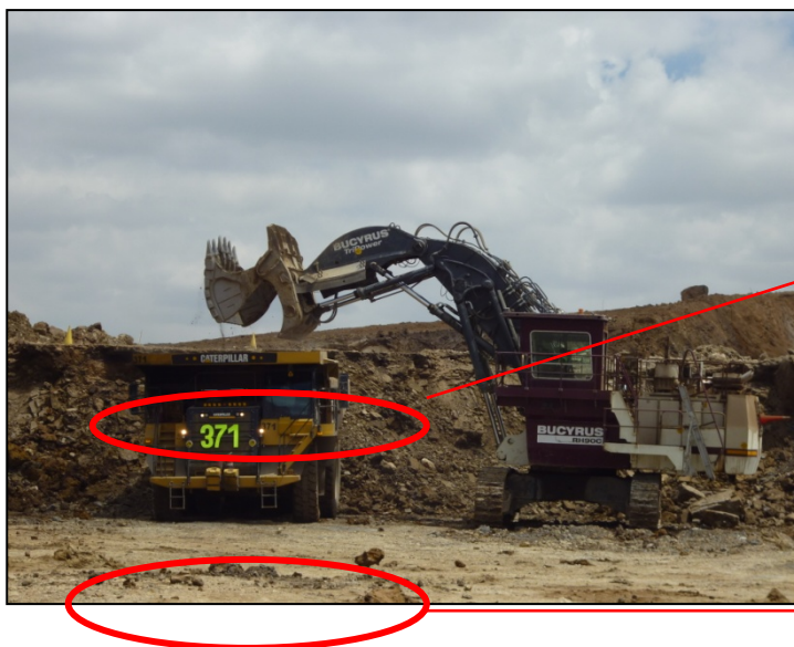
Figura 38. Frente con problemas de fragmentación
