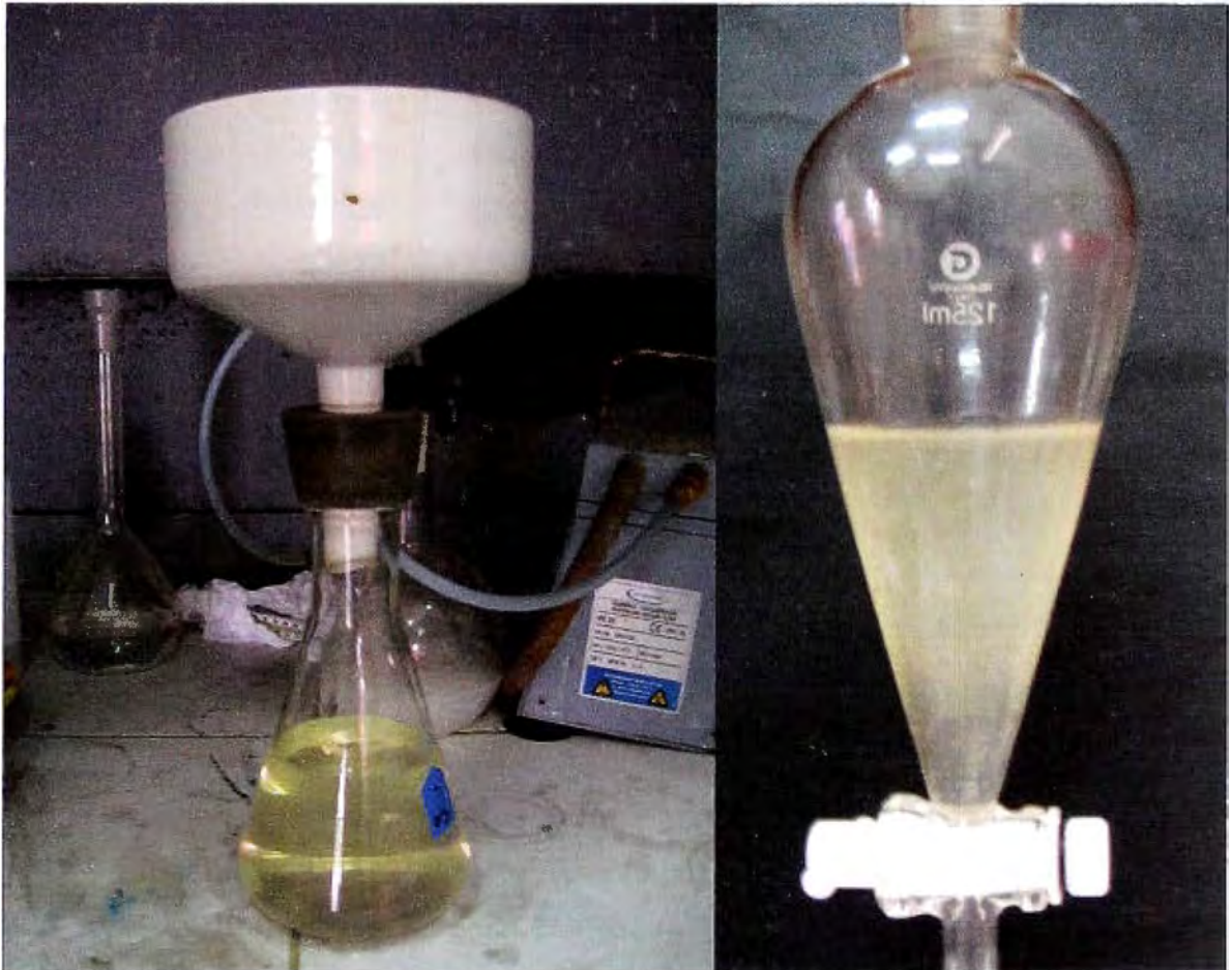
FIGURA N° 6.4 FILTRACIÓN Y EXTRACCIÓN
