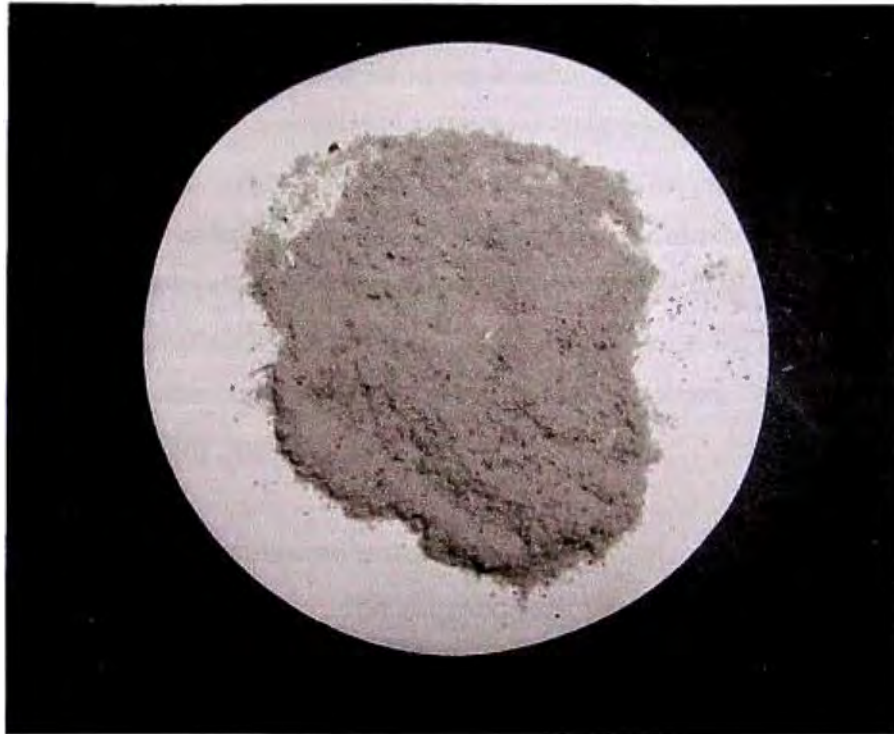
FIGURA N° 5.2 PETW BASE SIN LIMPIAR
