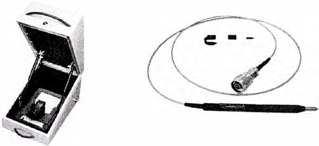
Figura 2.4. Caja de Faraday para aislamiento RF, permite realizar pruebas sobre terminales móviles sin interferencias externas, y Punta de pruebas para analizador de espectro protegida para descargas estáticas (Vcc) y con 20 dB de atenuación. Sus múltiples accesorios permiten un fácil acceso a puntos de medición dentro de la placa del terminal.
