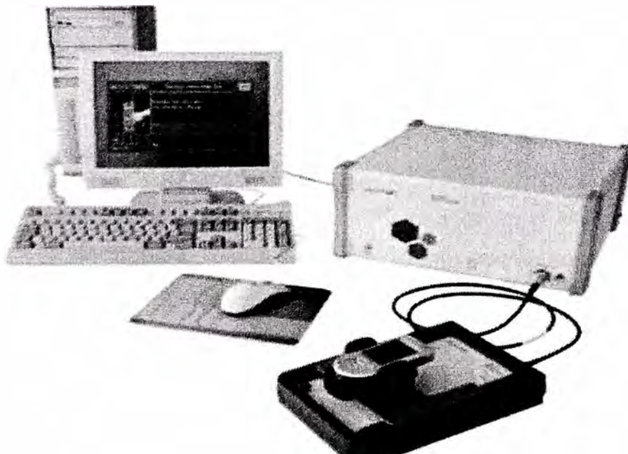
Figura 2.5. Plataforma compacta de Willtek desarrollada para realizar pruebas automáticas sobre terminales móviles GSM, EDGE y WCDMA. El instrumento es manejado mediante una PC por lo cual todos los resultados pueden ser manejados digitalmente. El 3100 puede ser actualizado a CDMA.
