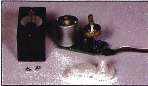
Fig. 2.9b Partes de un Servomotor
