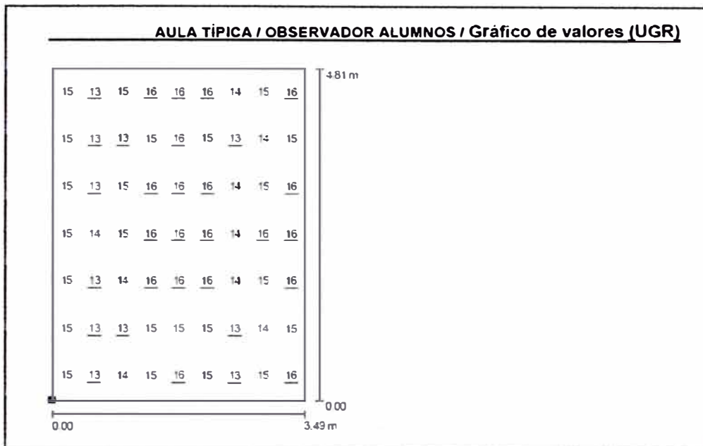
Fig. Nº 3.12 Resultados del cálculo de UGR realizado mediante software para el observador alumnos
