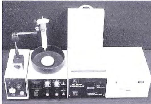
Figura 2.8 Sistema para aplicación de fotopolímero por rotación, que incluye dispensador, tornamesa, plancha calefactora y unidad de curado
