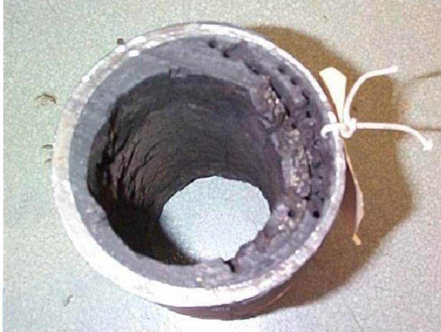
Figura N°4.13: Formación de coque
