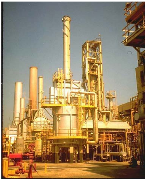
Figura 2.4: Horno Cilíndrico Vertical
