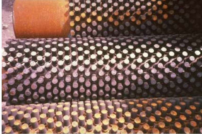
Figura 2.15: Tubos entetonados –Stud tubes
