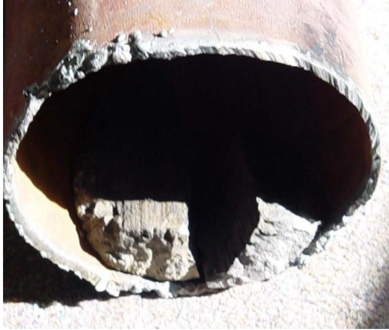
Figura N° 4.11: Fenómeno de Creep
