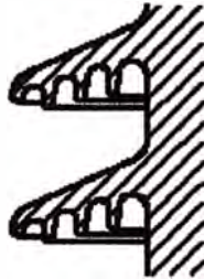
e) Salientes inferiores profundas en porcelana varilla larga, postes y recubrimientos
