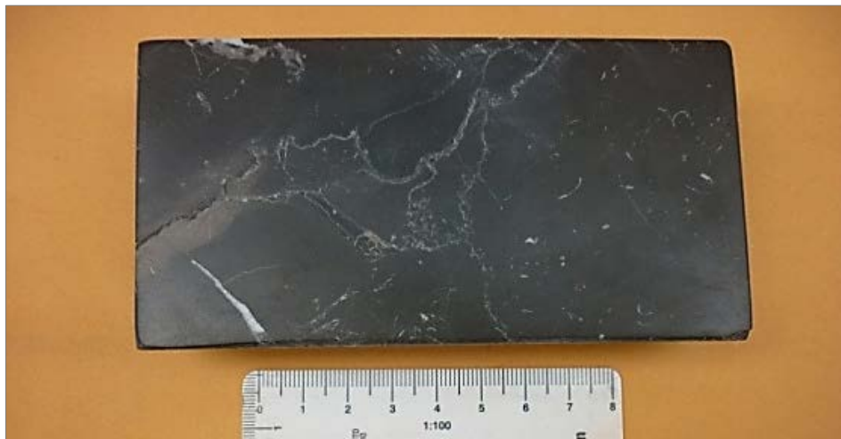
Figura 2.7: Caliza floatstone crinoidal de color gris oscuro y grano fino, con presencia de esporádicos crinoides en matriz bituminosa.
