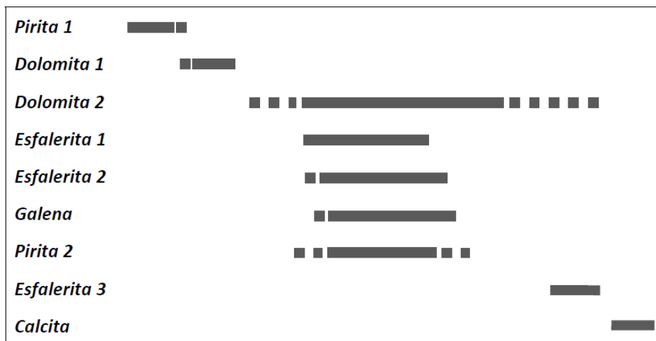
Figura 3.12: Secuencia paragenética generalizada para el depósito de Cañón Florida (Modificado de Reid, 2001).
