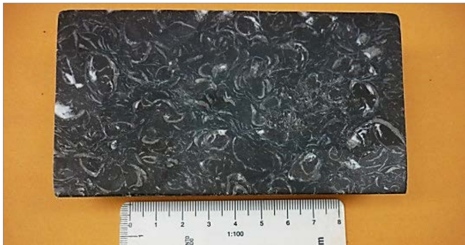
Figura 2.13: Caliza rudstone marcador bivalvo intacto (IBM) caracterizado por presentar abundantes valvas intactas de diámetro de 1 a 2 cm.
