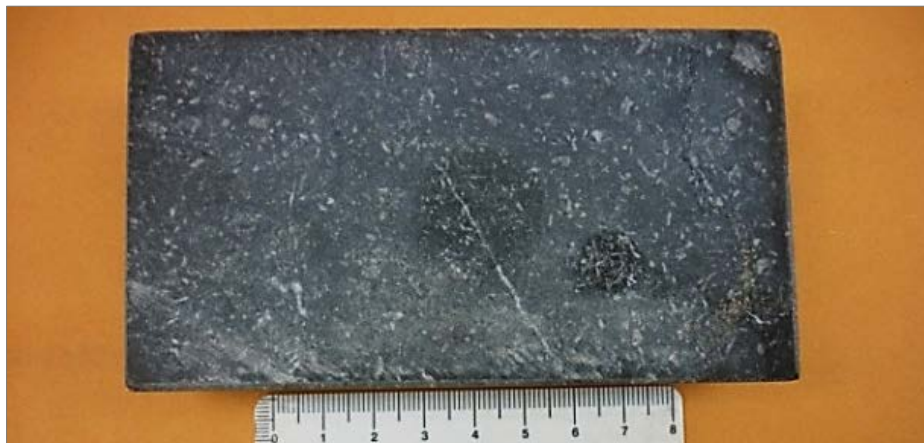
Figura 2.8: Caliza packstone crinoidal pelletal, gris claro, de grano medio con abundantes crinoides y pellets de grano soportados.
