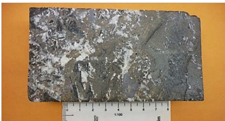
Figura 3.11: Esfalerita y galena relleno espacios en brecha de colapso homolítica.
