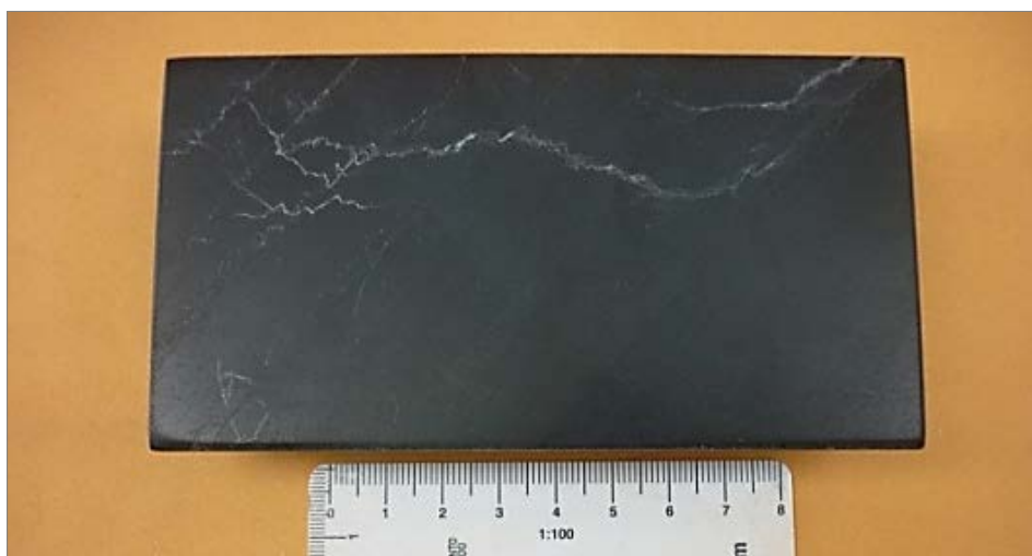
Figura 2.6: Caliza mudstone bituminosa de color gris muy oscuro y grano fino; mostrando venillas de calcita.
