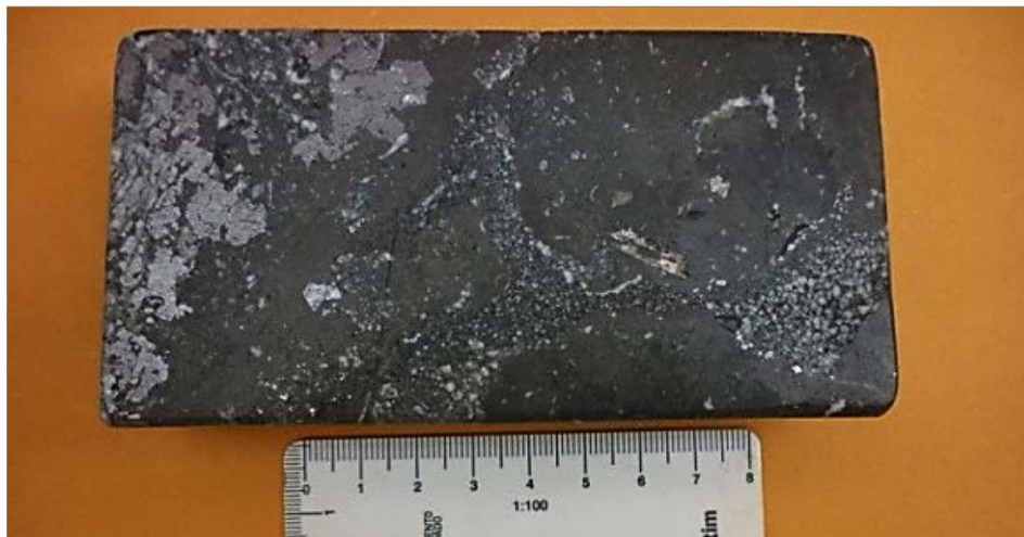
Figura 3.10: Esfalerita y galena masiva reemplazando a dolomita packstone pseudobrecha.
