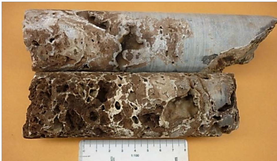
Figura 3.9: Muestras con cavidades kársticas, como producto de disolución de la caliza por aguas meteóricas descendentes conteniendo \text{CO}_2 y \text{H}_2\text{CO}_3 .
