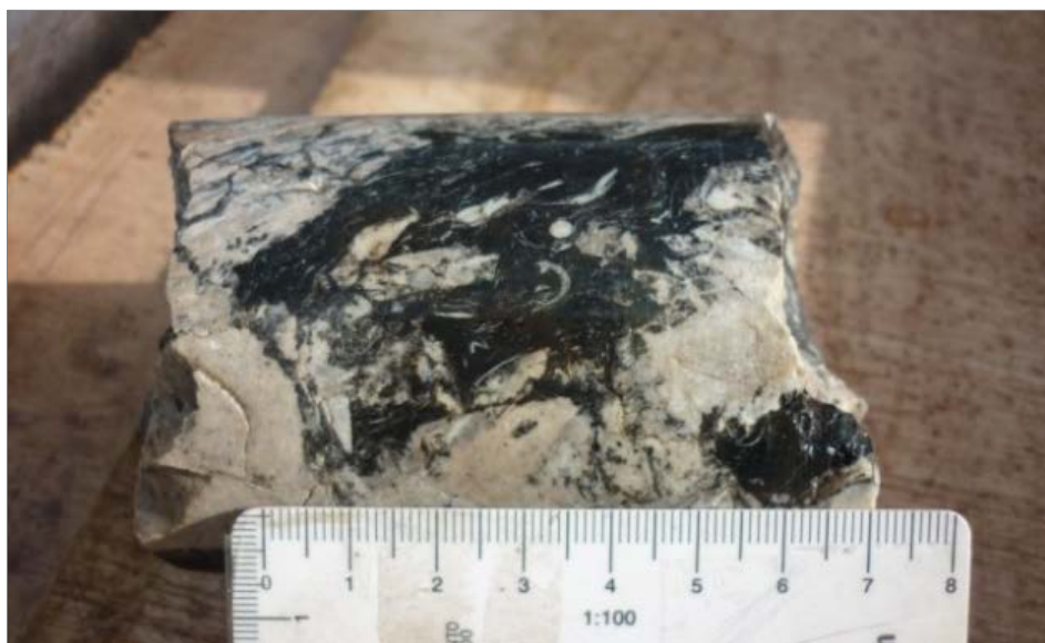
Figura 3.5: Brecha evaporítica con ocurrencias de pseudomorfos de dolomita reemplazando a cristales de yeso y matriz bituminosa.
