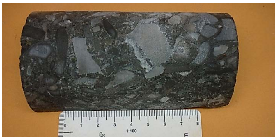
Figura 3.4: Brecha de colapso heterolítica con fragmentos de caliza packstone gris clara y gris oscura, de geometría subredondeada y matriz de roca molida.
