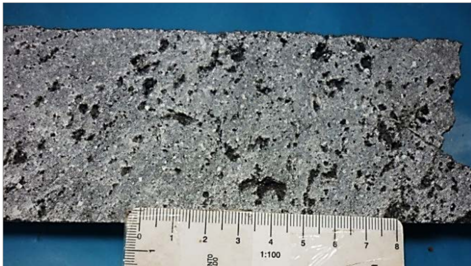
Figura 3.8: Dolomita Packstone mostrando porosidad secundaria por presencia de cavidades por disolución en condiciones hidrotermales ascendentes, hay desarrollo de cristales de dolomita en las oquedades.
