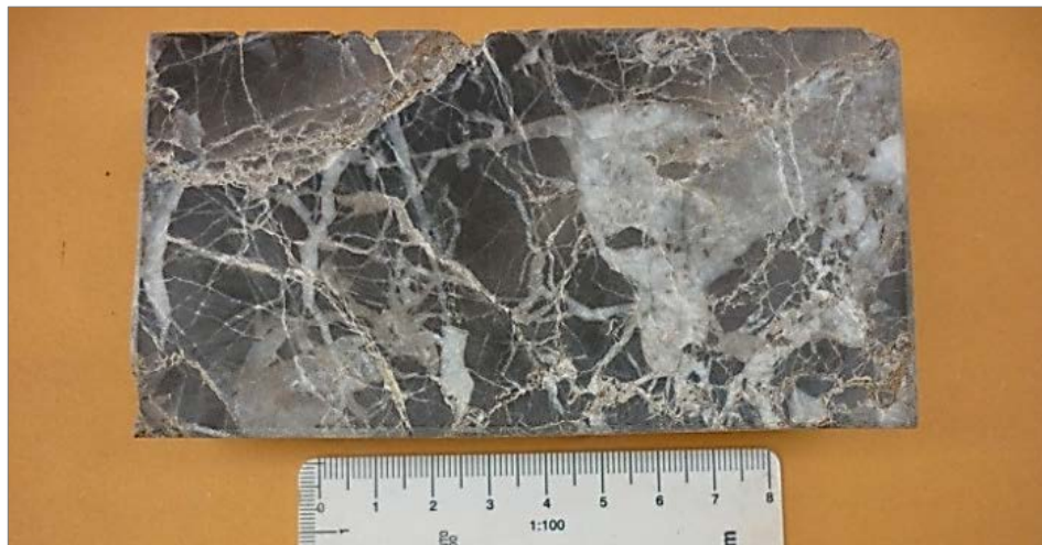
Figura 3.2: Brecha Mosaico, clasto soportado, fragmentos de caliza mudstone con geometría subangulosa y matriz dolomítica.
