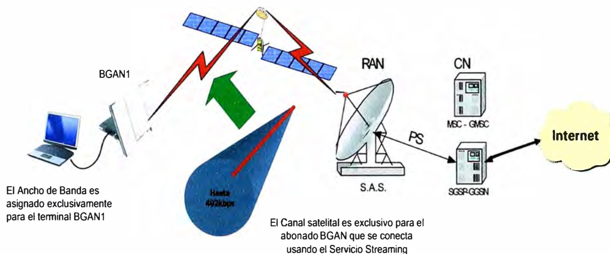
Figura 3.5 Funcionamiento del Servicio IP Streaming. Fuente: Elaborado a partir del Grafico 2.10
