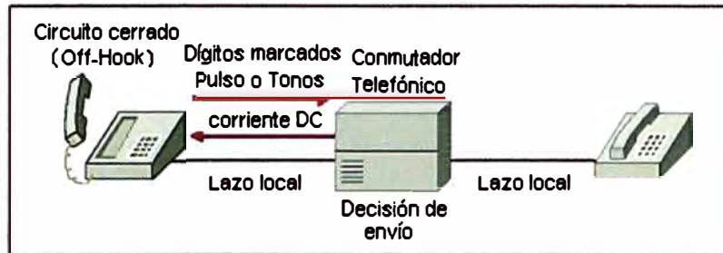
Fig. 2.8 Señalización básica de una llamada. Paso 2
