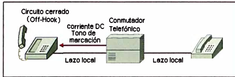
Fig. 2.7 Señalización básica de una llamada. Paso 1 y 2
