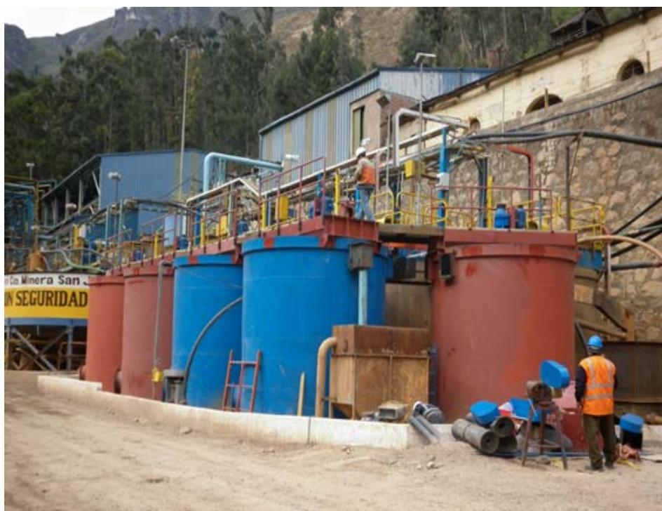
Figura 2.1 Tanques de neutralización en serie
