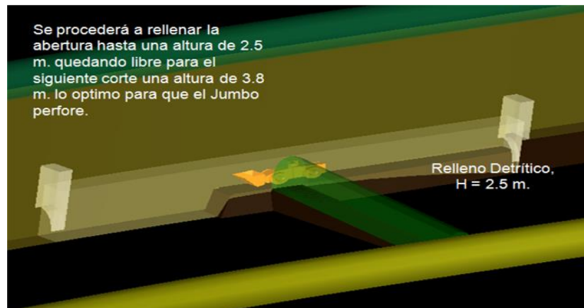
Figura 37: Relleno detrítico luego de culminar la limpieza del primer corte
