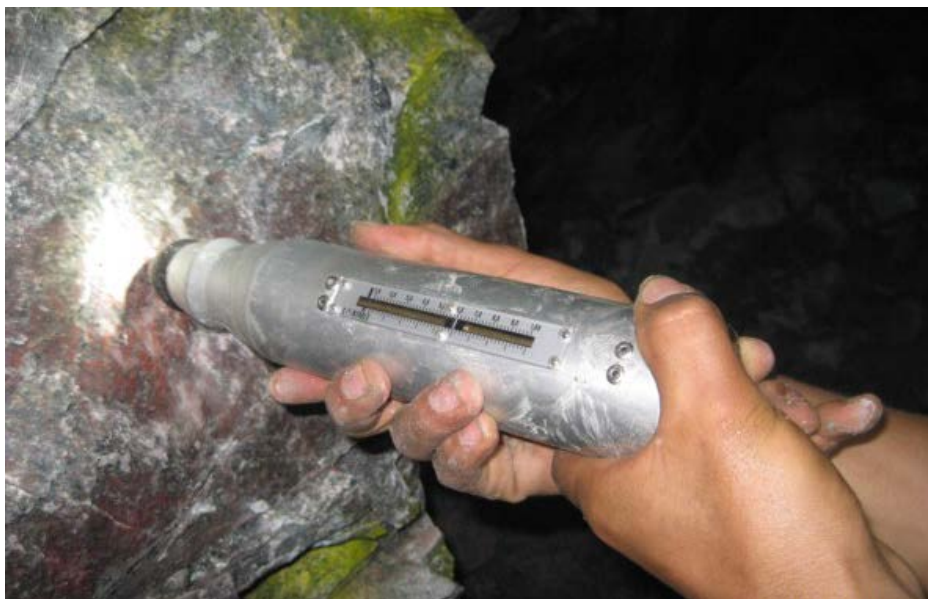
Figura 3.2 Ensayo martillo Schmidt
