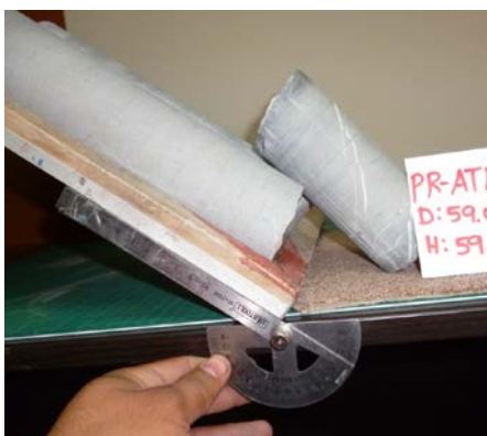
Figura 3.3 Ensayo tilt test
