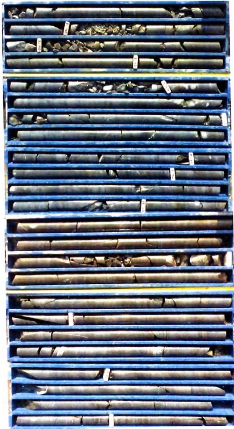
Foto 91: Perforación PR-03 de 0,00 m hasta 22,30 m.
