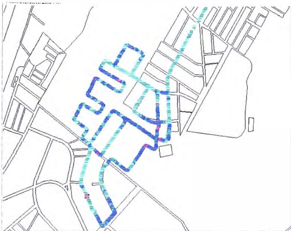
Fig. 4.15 Muestra del Drive test por las principales calles de Huanta
