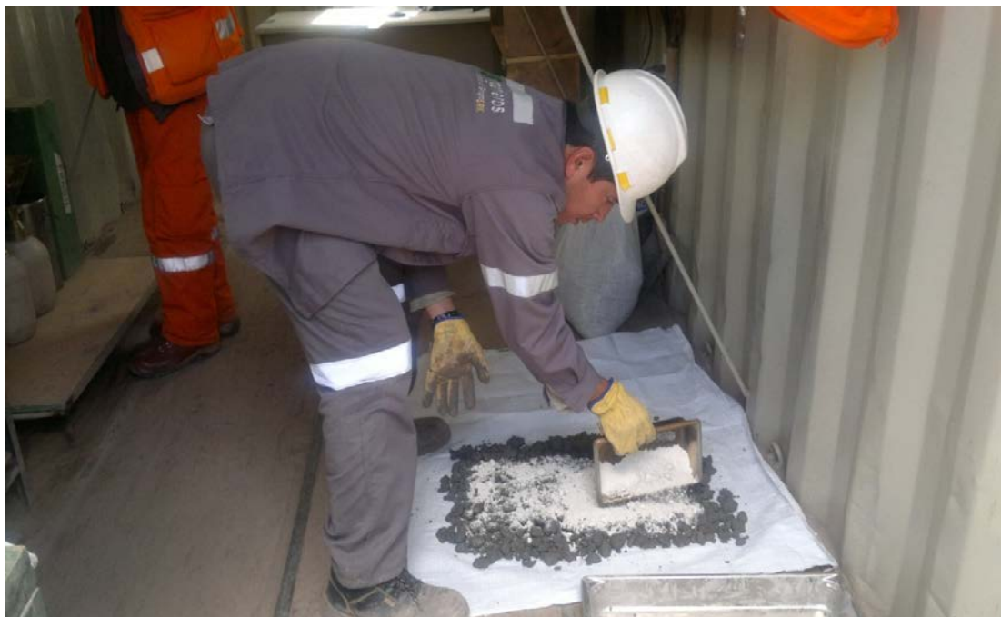
Mezcla de Material de Relave con CAL, luego de una hora de mezclado. Fuente: Catalina Huanca Sociedad Minera S.A.C.
