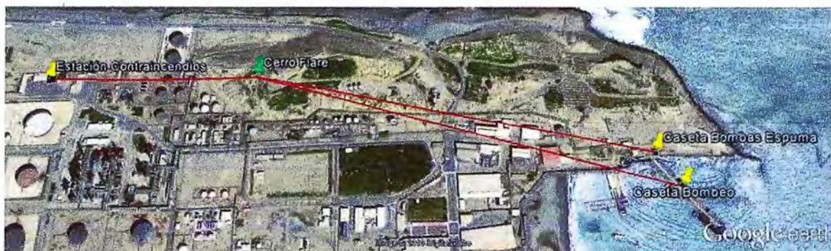
Figura 4.13 Enlaces del Repetidor Cerro Flare
