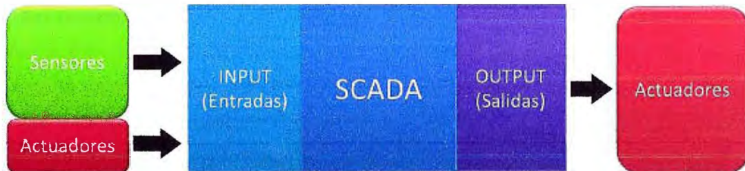
Figura 2.5 Interacción SCADA – Proceso (Fuente: Elaboración propia)
