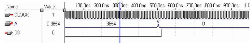
**Fig.4.8: Simulación digital del subsistema COMPARADOR**
