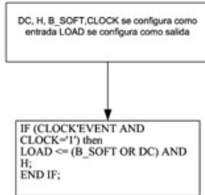
**Fig.6.1:Diagrama de flujo del subsistema C \_LOGICO. VHDL**
