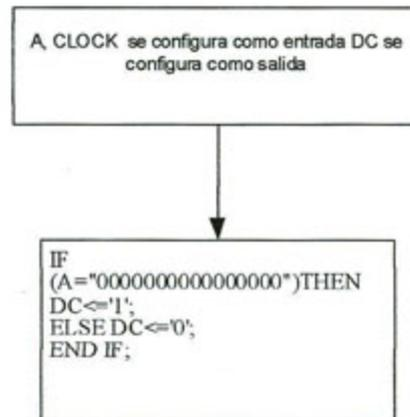
**Fig.4.7: Diagrama de flujo del subsistema COMPARADOR. VHDL**
