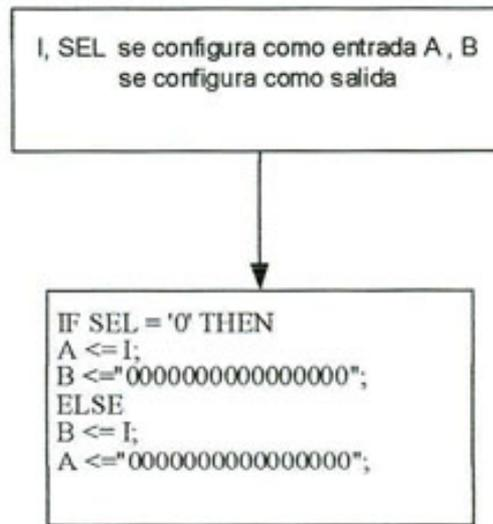
Fig.3.3:Diagrama de flujo del subsistema DEMUX \_C. VHDL
