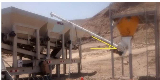
Figura N° 7. 4. Ángulo de inclinación de gusano transportador
