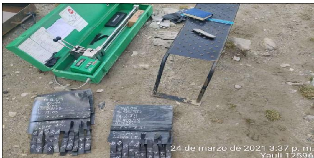
Figura 28: Pruebas preliminares para el control de calidad de geomembranas
