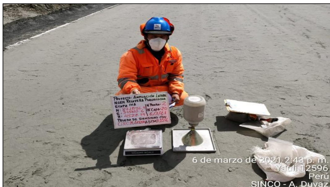
Figura 27: Control de compactación en el dique de contención
