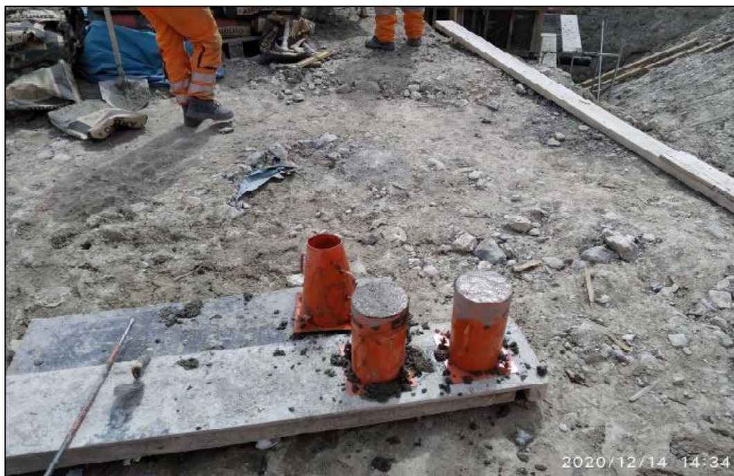
Figura 21: Fabricación de testigos de prueba en obra
