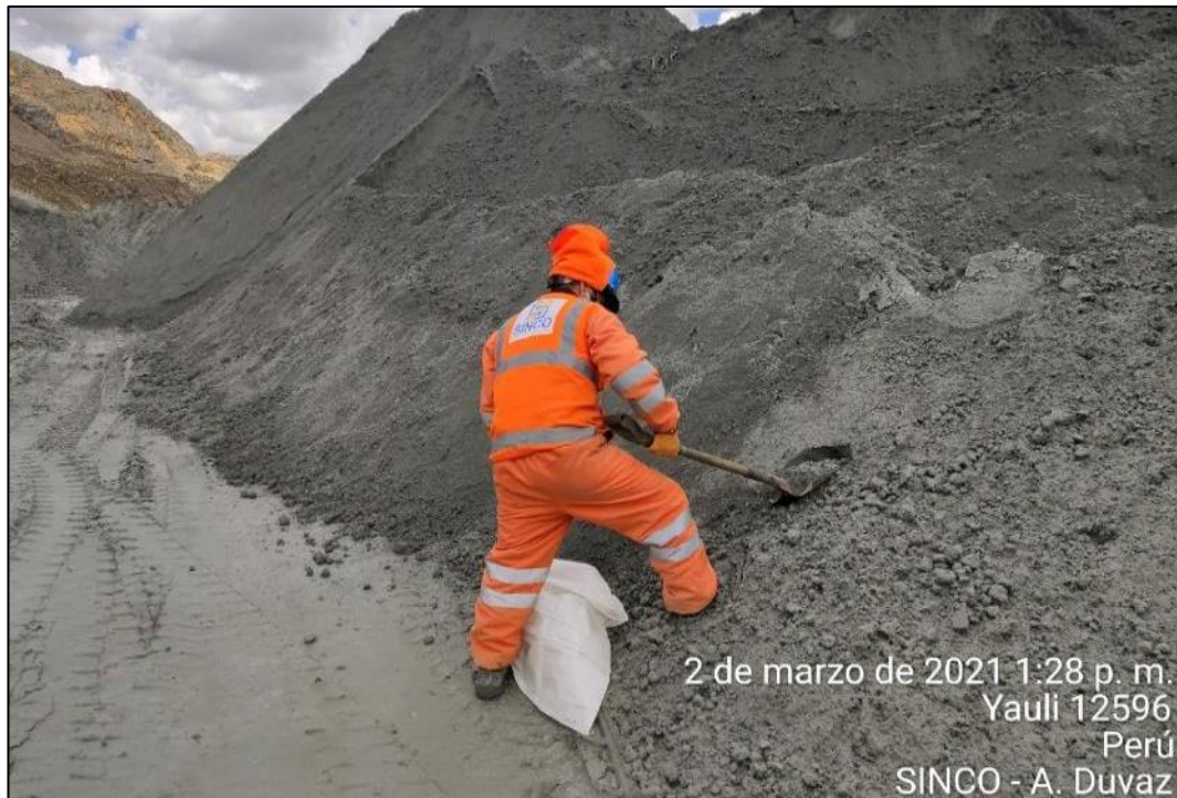
Figura 25: Extracción de muestras de relave grueso
