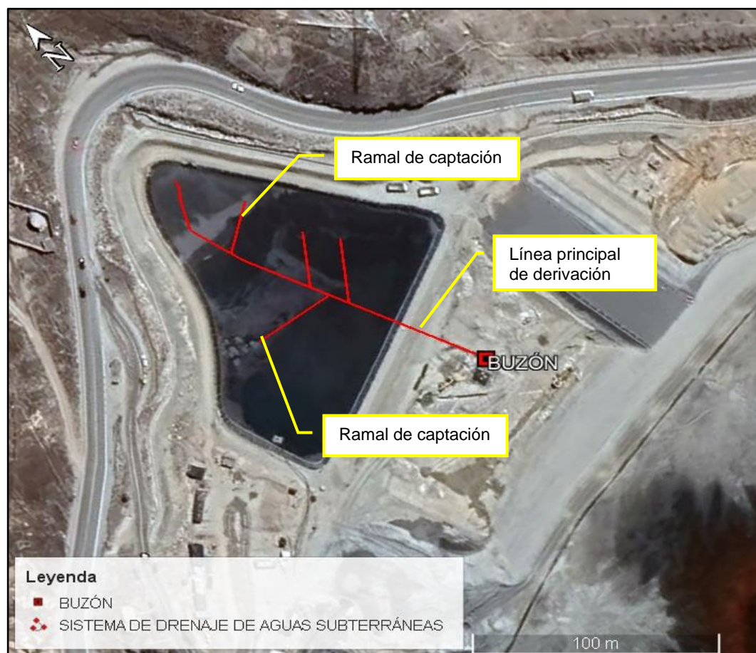
Figura 12: Sistema de drenaje de aguas subterráneas
