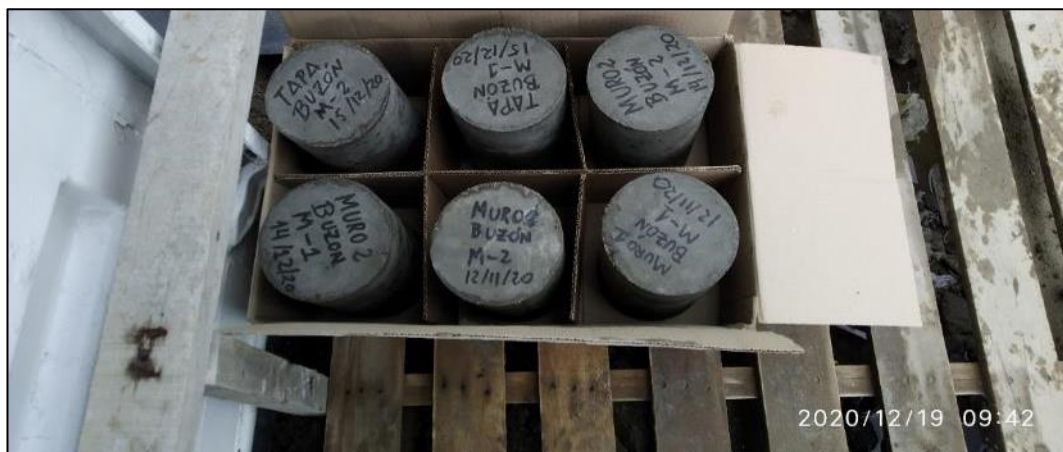
Figura 23: Testigos de prueba codificados en obra
