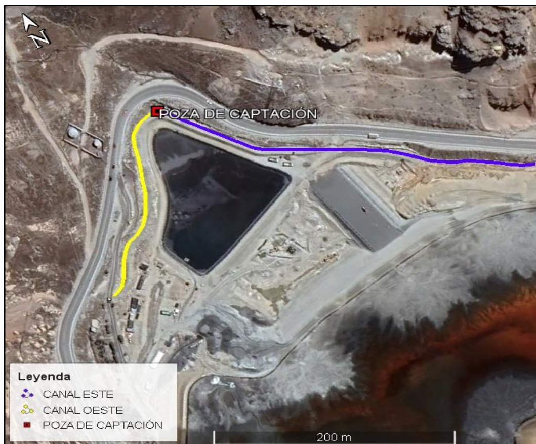
Figura 14: Sistema de drenaje de aguas superficiales
