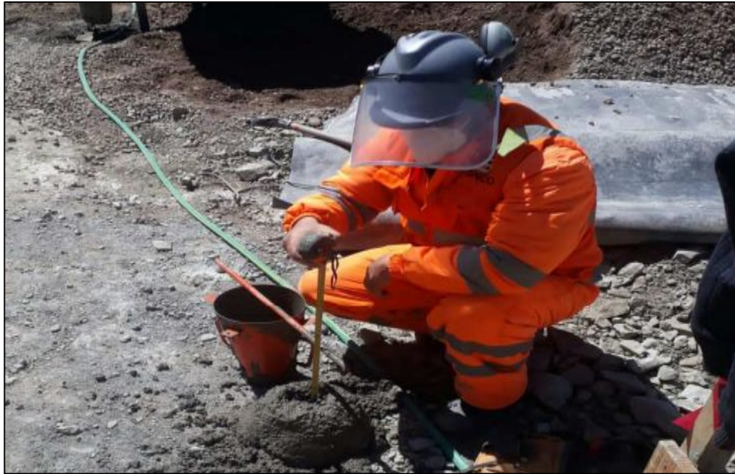
Figura 22: Prueba de asentamiento del concreto en obra
