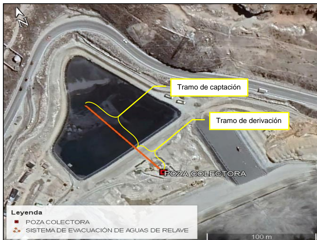
Figura 18: Sistema de evacuación de aguas de relave
