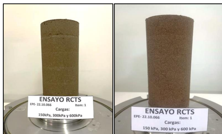
Figura N°40. Muestras sometidas al ensayo RC-TS (Moya, L. et al., 2021).
