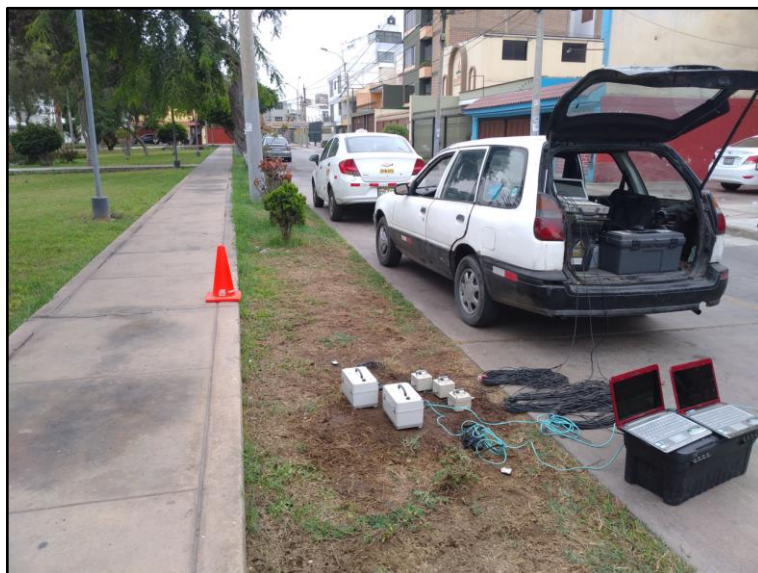
Figura N°12. Ensayo de medición puntual de microtremores realizado en el distrito de San Miguel.
