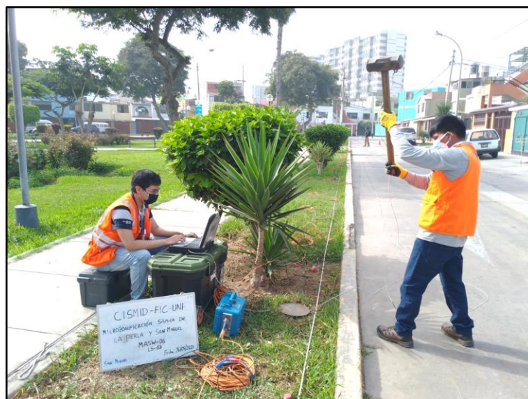
Figura N°10. Ensayo de Refracción sísmica realizado en el distrito de San Miguel.
