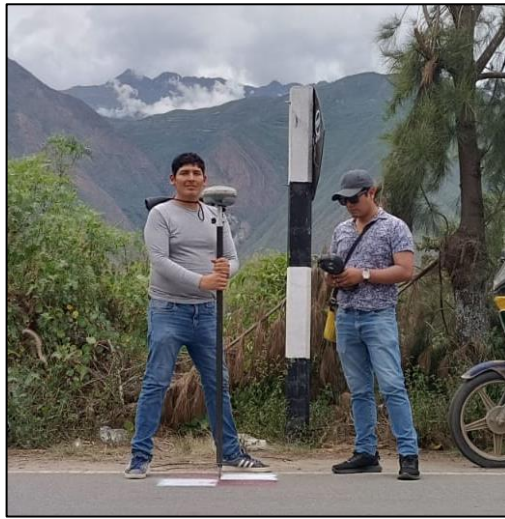
Figura N°3.17: Levantamiento de puntos de control con método RKT
