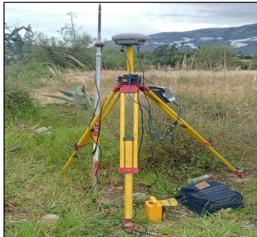
Figura N°3.16: Receptor GNSS con radio externo en punto de orden C
