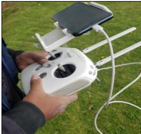
Figura N°3.18: Control de vuelo de dron con mando y celular
