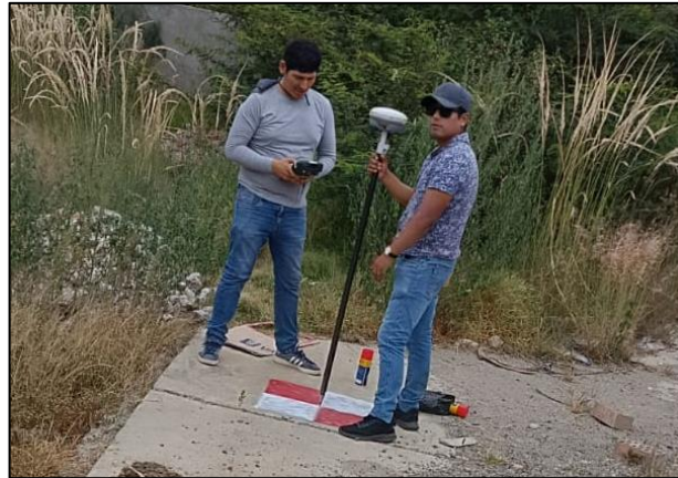
Figura N°3.15: Colocación de dianas para puntos de control
