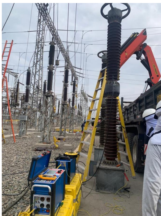
Figura 4.3: Pruebas al transformador de tensión desmontado de la fase "S".
