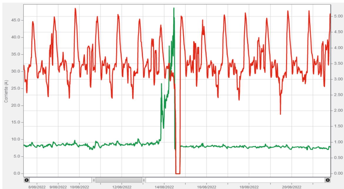
Figura 3.25: Gráfica del desbalance de corriente presentado en la barra de 22.9 kV de la SE Ayaviri
