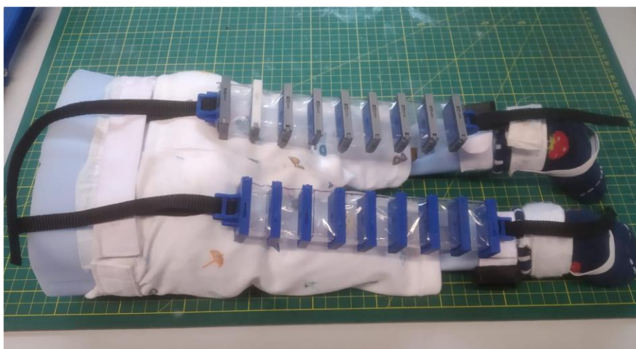
Figura. 1.4 Exoesqueleto flexible montado en una maniquí de bebé de 6 meses.
